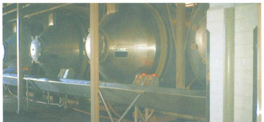
Depósitos giratorios para la elaboración de vinos tintos
