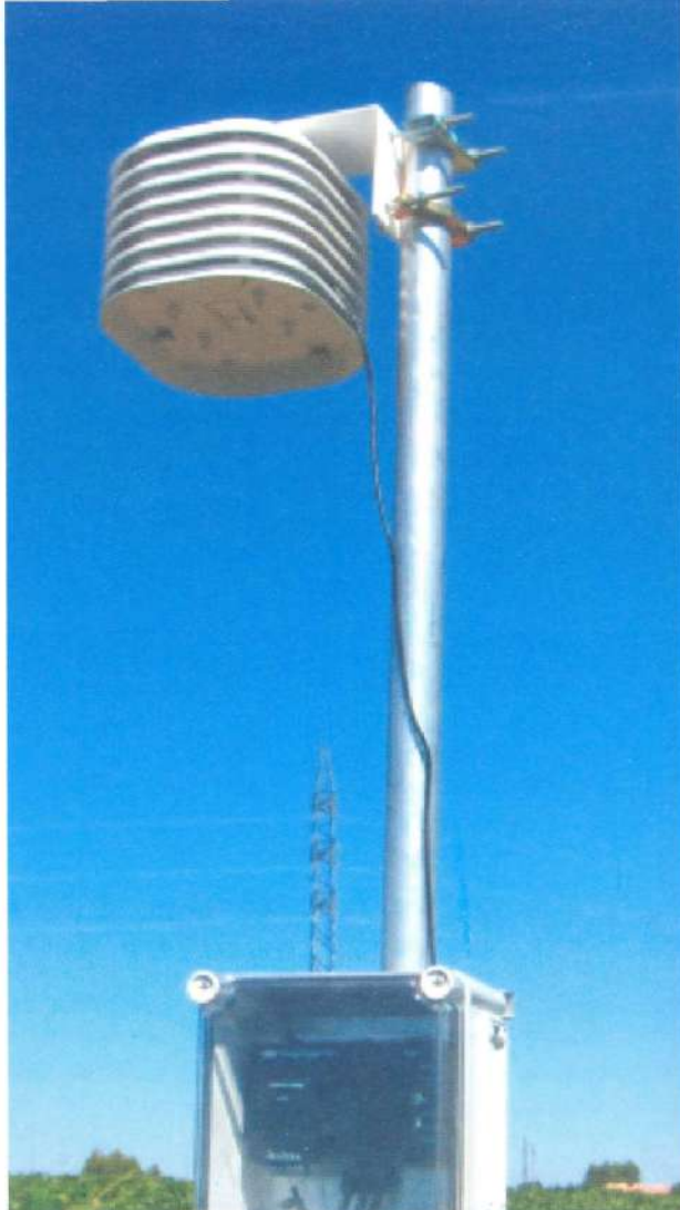
Figura 3.-Pluviómetro, Sonda ambiental y datalogger.
