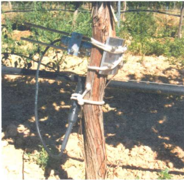
Figura 1.-Dendrómetro instalado en la cepa.
