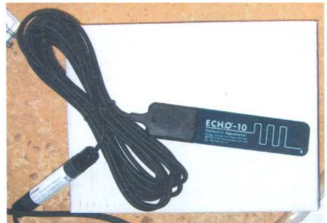
Figura 2.- Sonda de capacitancia.
